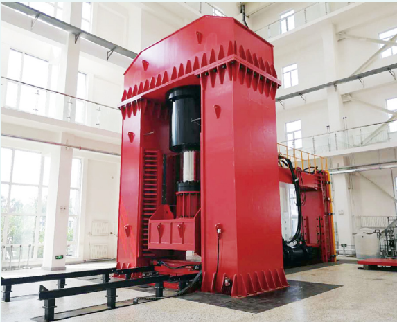
基础条件 4-20000kn 结构动态压剪试验系统
