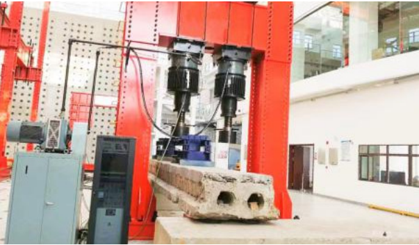
基础条件 6-3000kN 电液式多功能疲劳试验机
