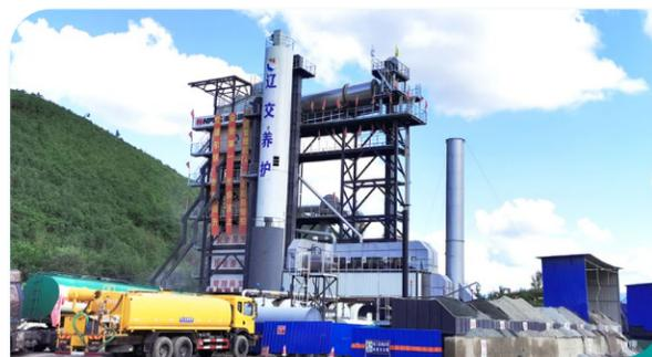
《沥青路面固废资源化高效循环利用成套技术与装备研发》项目研究成果沥青混凝土厂拌热再生在辽宁省恒永高速公路、阜锦高速公路等路面维修养护工程实现大规模应用
